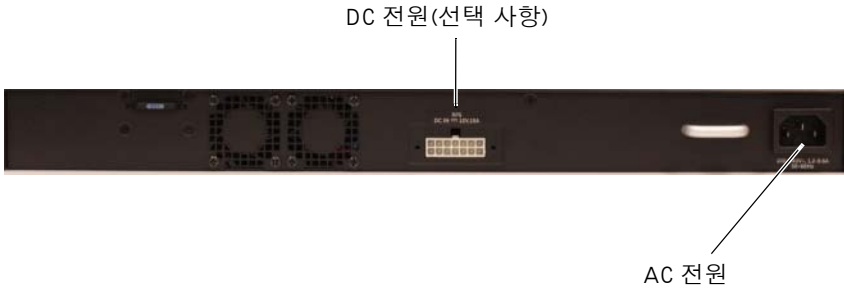
그림 1-10. N1548 스위치에 AC 및 DC 전원 연결
